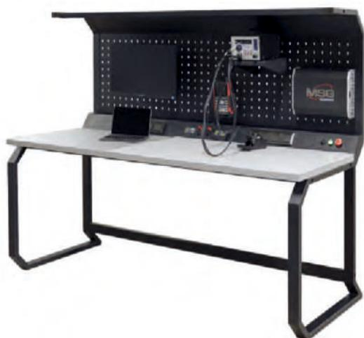
**MS570 工作台**是电子技术人员随时可用的工作场所。该工作台专为与MS561 测试仪(用于 EPS 维修的诊断系统)一起使用而定制。它有两个内置的实验室电源模块，并为示波器和焊接台预留了空间。工作台配有安装装置，可安装任何尺寸的显示器。所有涉及电子维修的操作都需要明亮的局部照明。工作台配备了 LED 灯具，输出功率为 60 W LED照度为 750 l，可满足高精度操作的要求。
