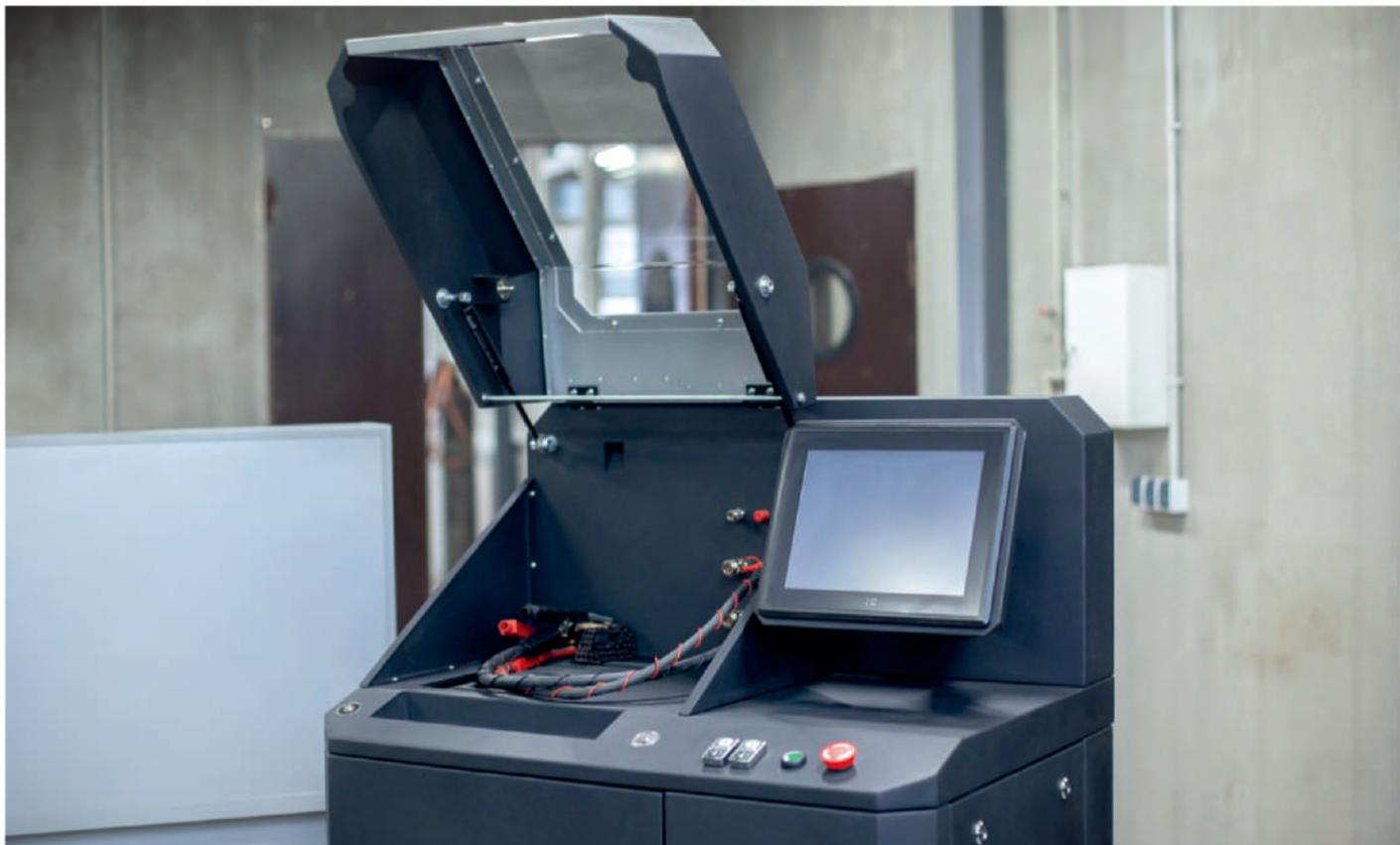
**MS005**-多功能测试台，用于快速准确地诊断轿车和卡车的交流发电机和起动机。测试台软件定期更新，以扩大诊断设备的范围。
