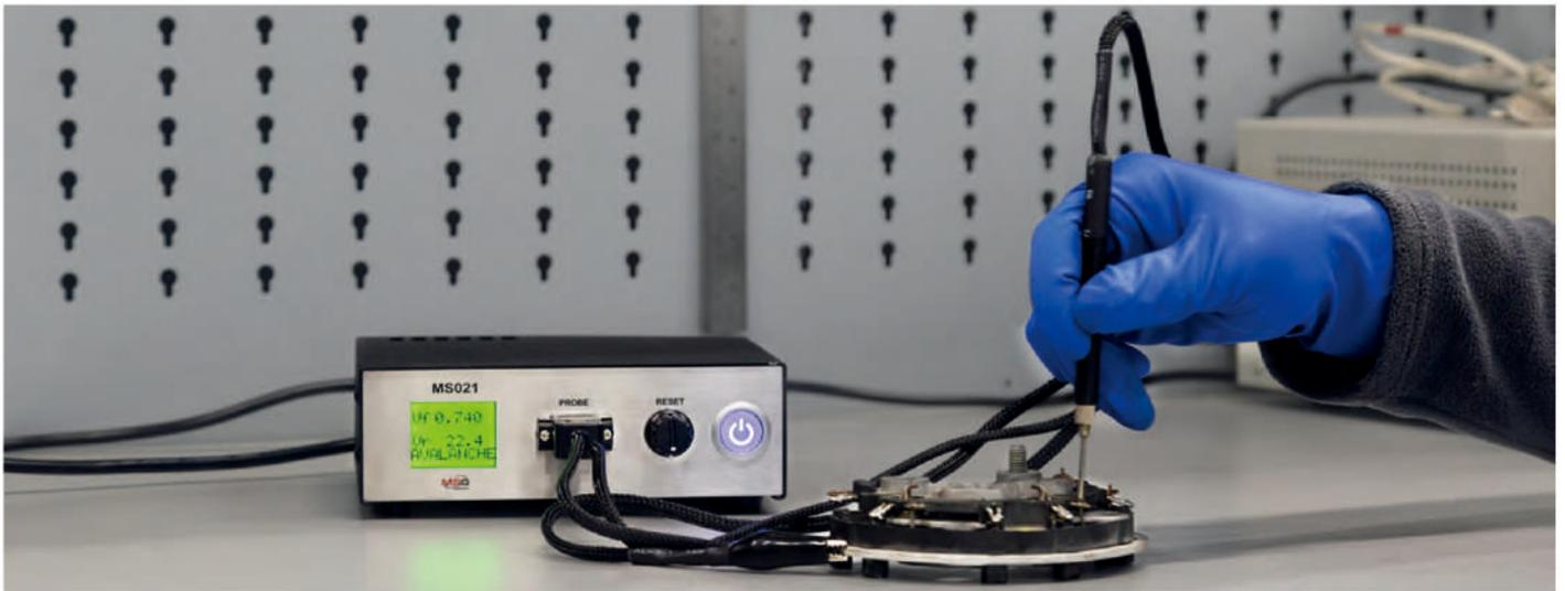
MS021 测试仪可确保准确测试交流发电机二极管桥和单个二极管的技术状况。该测试仪可识别被测二极管的类报告缺陷类型和性能特征，并识别二极管的退化情况。
