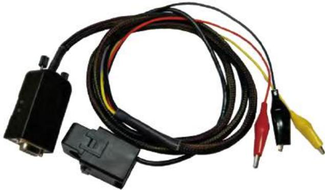
MS016 测试仪与 MS-33503A 电缆一起使用时，可以记录起动机端子上的电压值:31、30 和 45 端子上的电压值以及 30 端子上的电流值。测量结果以图表形式显示在测试仪屏幕上。这些信息有助于识别起动机的运行、汽车蓄电池或线路中的偏差。
