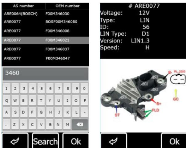
图 17.根据数据库搜索电压调整器和搜索结果
