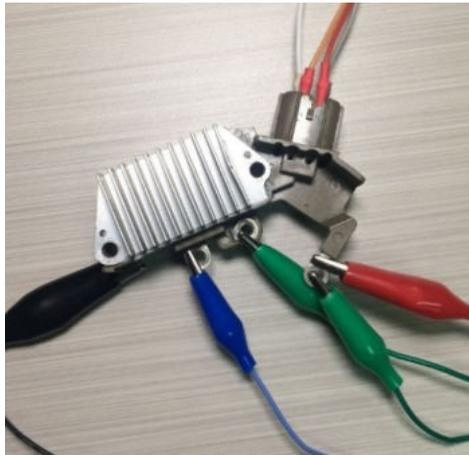
图 22.电压调整器 ARE6076 与测试仪的连接示意图
