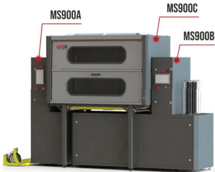
该系统由三个模块组成：MS900A - 诊断和干燥模块；
